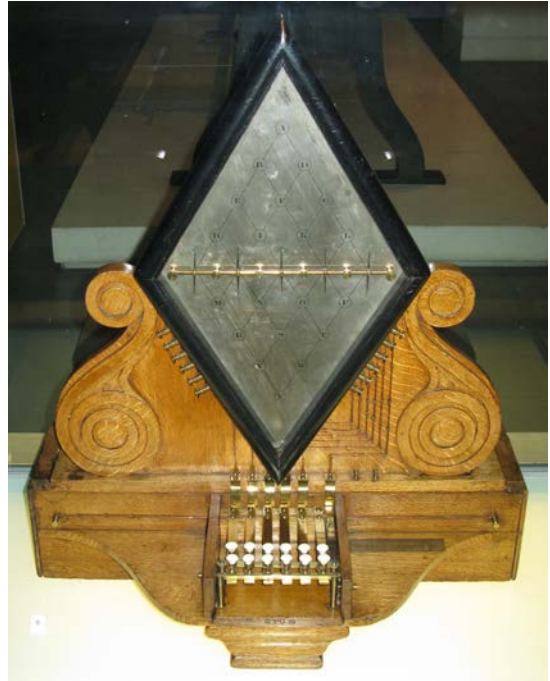
Cooke og Wheatstone brugte den elektromagnetiske effekt til at bevæge nåle i deres telegraf. Denne har fem nåle, som ved fælles hjælp kan pege på ethvert bogstav i alfabetet. Foto: Wikicommons
