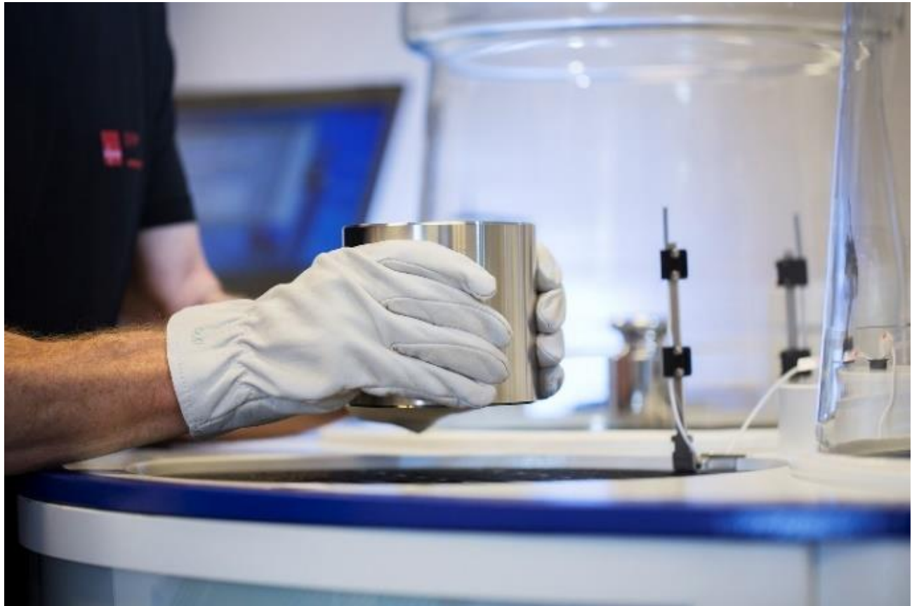
Fire forskellige massekomparatorer hos DFM gør det muligt for laboratoriet at kalibrere lodder i størrelsen fra 1 mg til 20 kg. Foto: DFM
